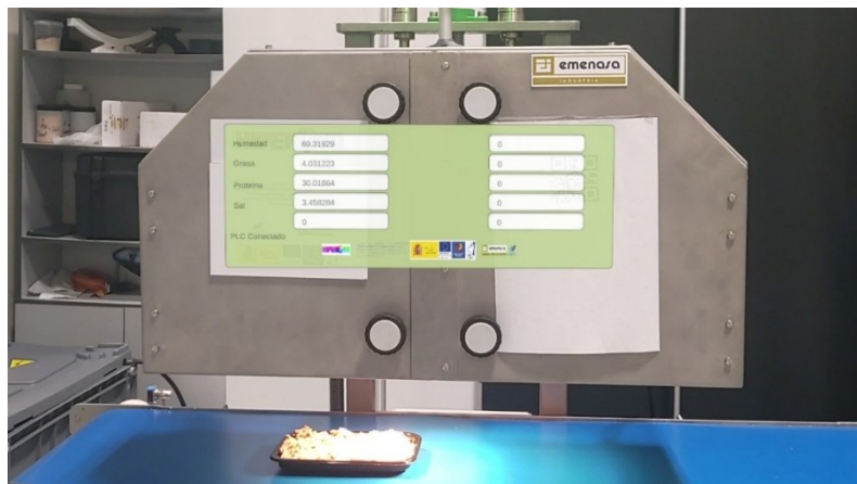
Ilustración 12: Panel de visualización de datos físico-químicos desarrollado con realidad aumentada.
