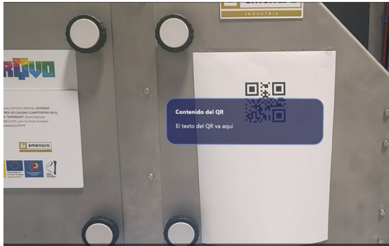
Ilustración 11: QR dispuesto en la máquina para la aplicación de realidad aumentada.
