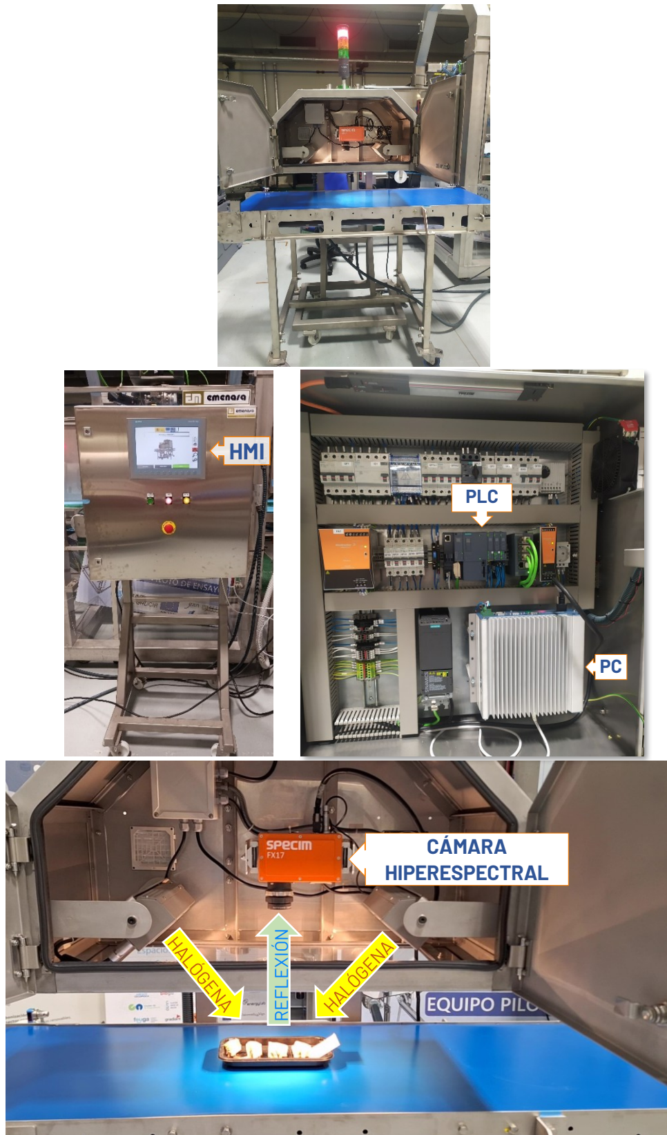
Ilustración 6: Arriba: campana de visión abierta y cinta. Centro: cuadro eléctrico y de control. Debajo: campana de visión con la cámara hiperespectral y las luminarias halógenas colocadas a 45 grados.
