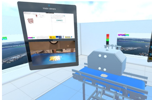
Ilustración 9: Animación en la cinta transportadora simulando su movimiento real y vídeos de apoyo.
