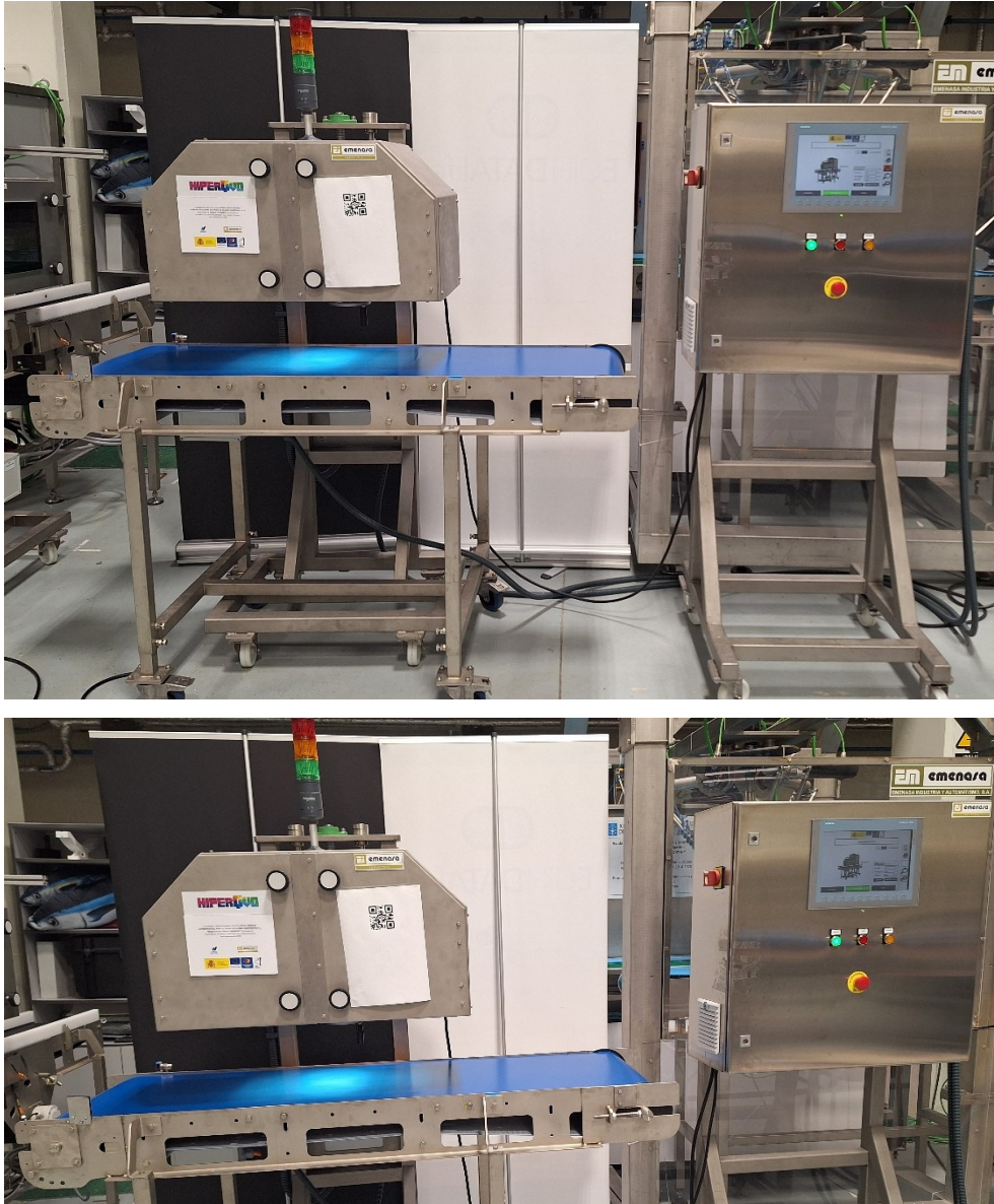
Ilustración 7: Prototipo HIPERQVO: campana de visión, cuadro eléctrico y de control; y cinta transportadora.
